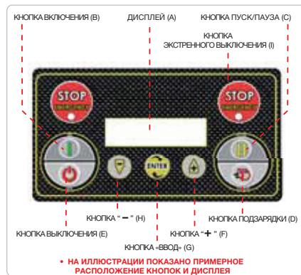
**D) ПОДЗАРЯДКА:** нажмите на кнопку для возвращения робота на станцию для подзарядки батареи. При нажатии на кнопку во время выполнения зарядки робот приступает к работе.
