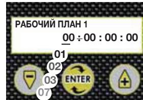
**РАБОЧИЙ ПЛАН 2:** установка второго периода рабочего дня робота.
